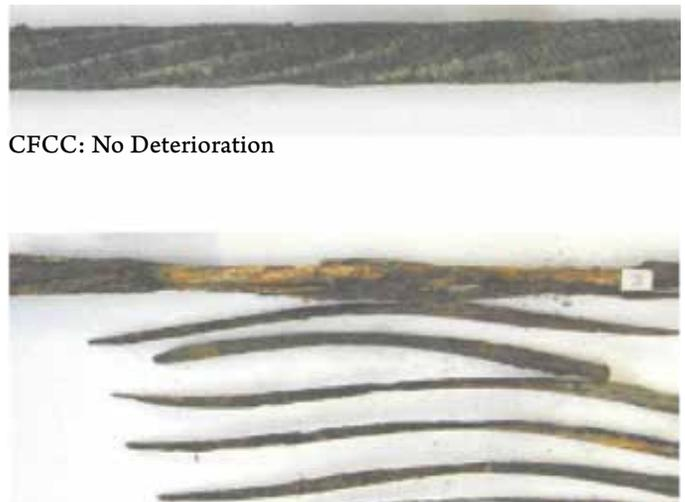
CFCC: No Deterioration
